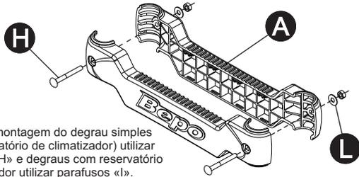
OBS: Para montagem do degrau simples (sem reservatório de climatizador) utilizar parafusos «H» e degraus com reservatório de climatizador utilizar parafusos «I».
