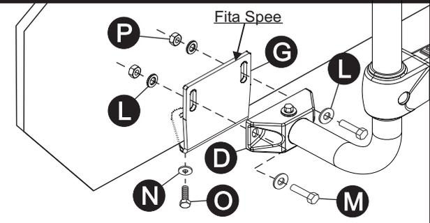
Fixe o tubo lateral 'B' com os suportes 'F', contra suporte 'Q' e pé plástico 'D' utilizando parafusos 'M', arruelas 'L' e porca 'P'.
