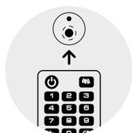
Aponte o controle remoto para o sensor do controle remoto da TV sem fio e use-o em um raio de 7 metros.
